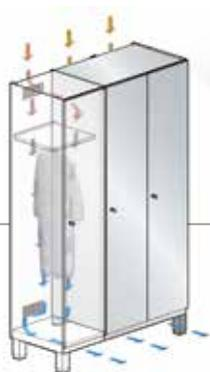
La construction particulière de l'armoire Cambio permet un meilleur écoulement d'air et garantit ainsi un séchage beaucoup plus rapide des vêtements humides – le tout garanti et sans dépenses d'énergie supplémentaires ! Pour les opérations de séchage spéciales, vous disposez également des concepts AF et AFS (→ Page 5).
